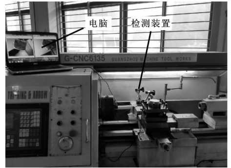
图5 现场刀具磨损检测装置
